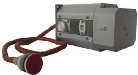
Комбінований трикомпонентний феррозондовий магнітометр для орієнтації супутників
